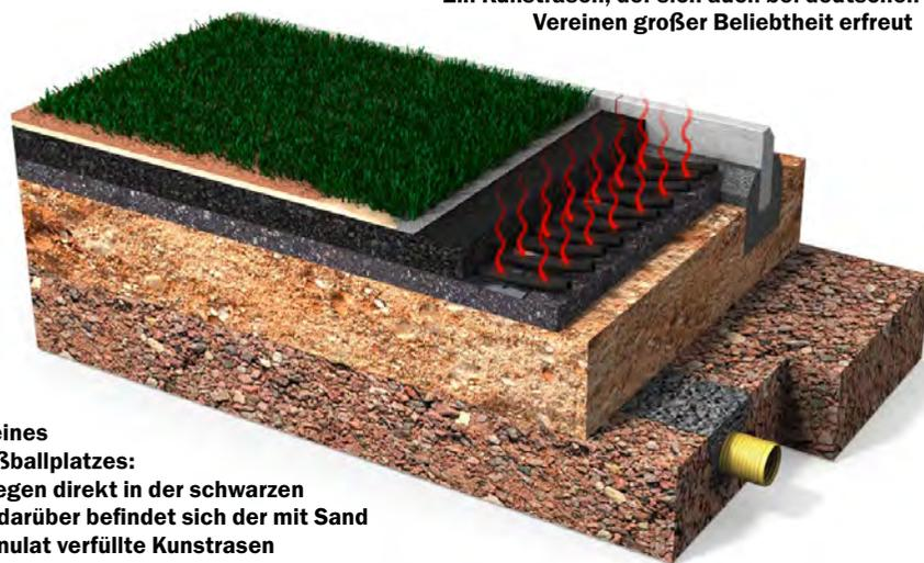
Systemaufbau eines beheizbaren Fußballplatzes: Die Heizrohre liegen direkt in der schwarzen Elastikschiene, darüber befindet sich der mit Sand oder EPDM-Granulat verfüllte Kunstrasen
